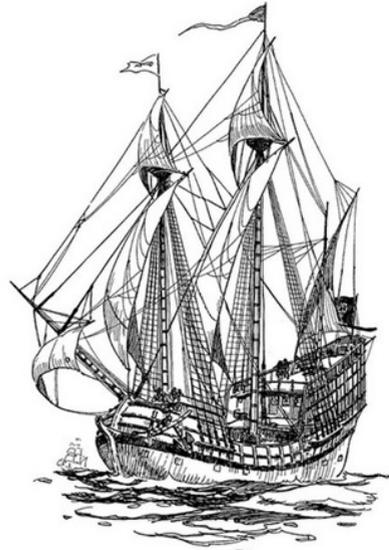
**Nau:** É uma embarcação com 30 metros de comprimento e 10 metros de largura, com três decks cobertos, castelo de proa e de popa com três pavimentos. Possui três grandes mastros. Do mastro da popa ergue-se uma grande vela triangular, o mastro central ergue duas velas quadradas sobrepostas e o mastro da proa ergue uma vela quadrada. Além disso, pode possuir um mastro menor na extremidade da proa, erguendo-se a um ângulo de 30° em relação ao mar, que pos-
